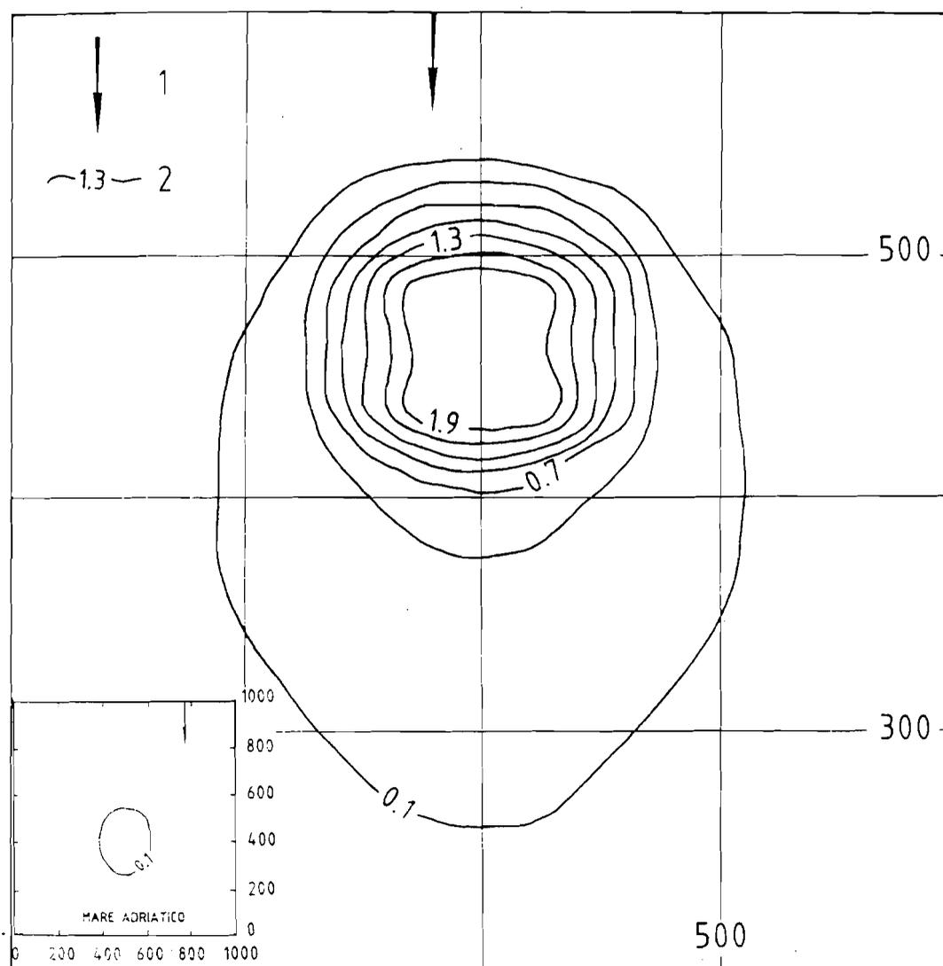
Fig. 10 - Variazione della temperatura dopo 1880 gg: (1) direzione del flusso naturale, (2) isoterma ( $C^{\circ}$ ).
