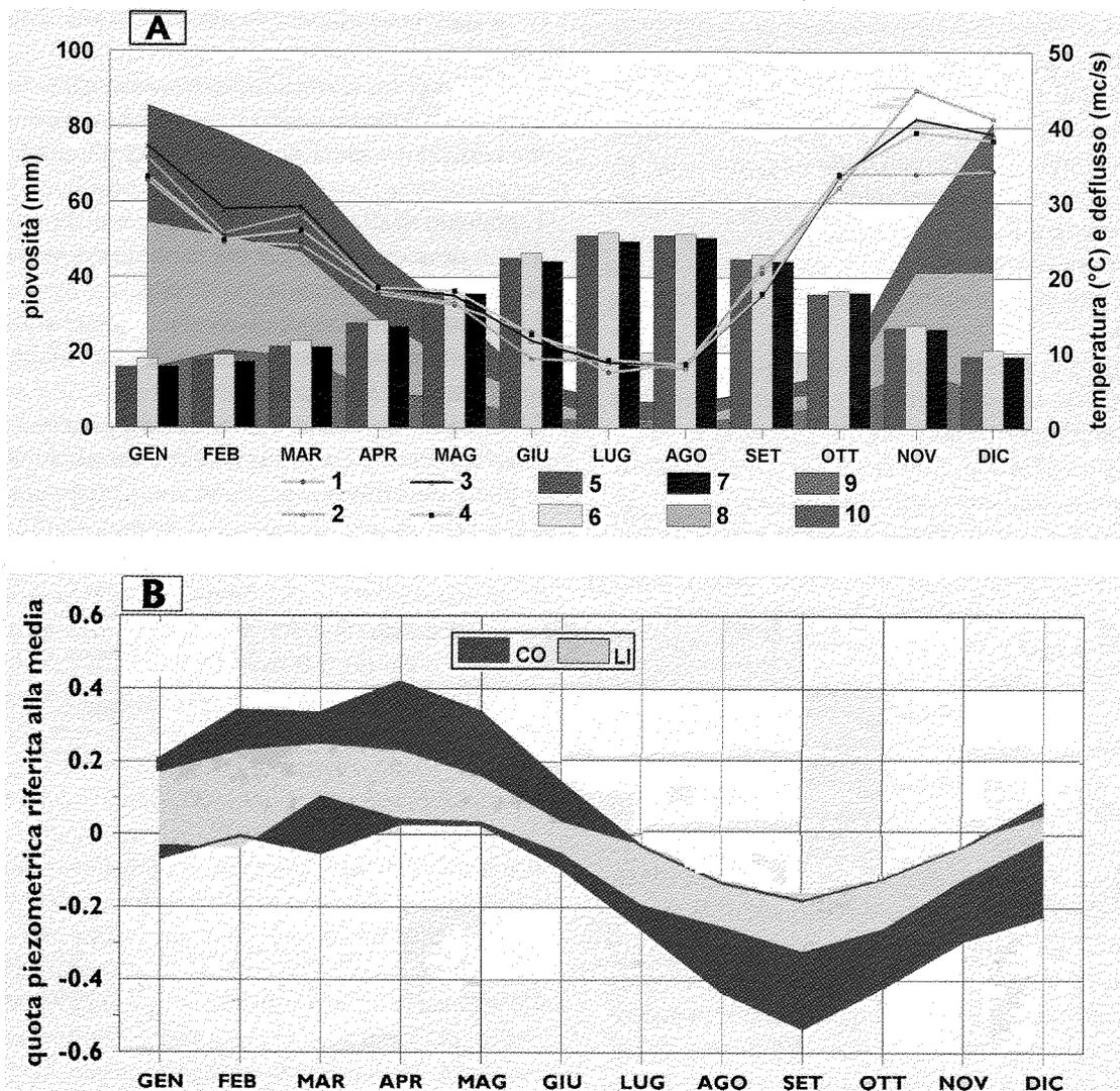
Figura 4: Relazione tra i regimi termopluviometrico, idrometrico e piezometrico. Diagramma A: stazioni pluviometriche di : 1) Metaponto, 2) Nova Siri Scalo, 3) Policoro, 4) S. Basilio; stazioni termometriche di 5) Metaponto, 6) Nova Siri Scalo, 7) Policoro; stazioni idrometriche del 8) F. Basento (Menzena), 9) F. Bradano (Tavole Palatine), 10) F. Sinni (Valsinni). Diagramma B: fuso definito dai regimi piezometrici dei pozzi in falda confinata (CO) e libera (LI).
