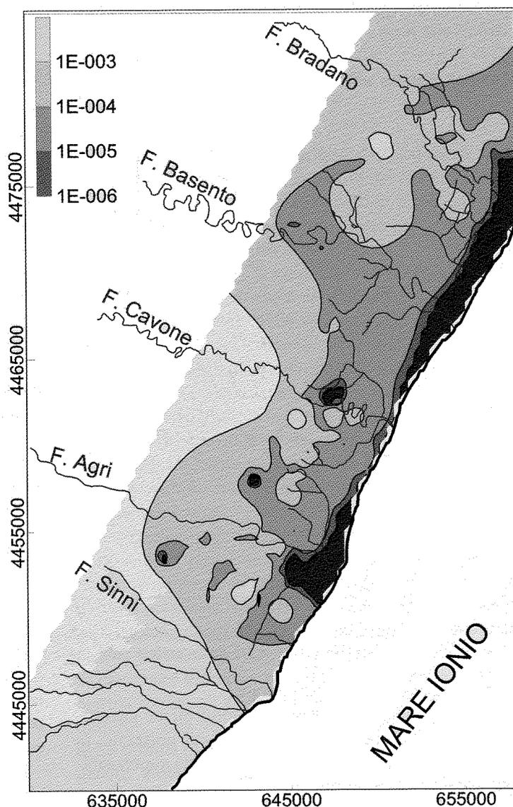
Figura 6: Distribuzione della conducibilità idraulica (m/s).
